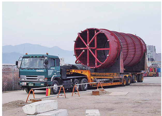
図2 回転ストーカ式焼却炉搬入状況
