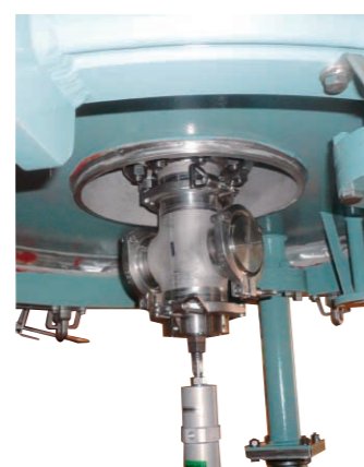
パイプレータ部
