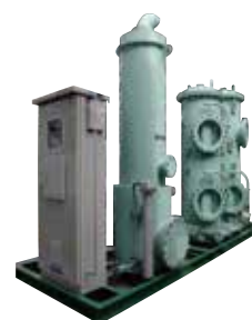
純水製造設備
