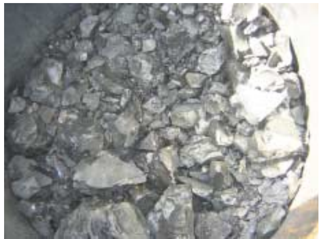
写真7 空冷後破碎したスラグ
