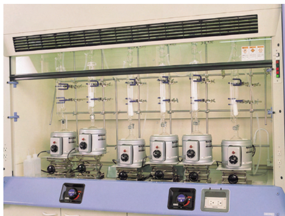
ダイオキシン類前処理設備
