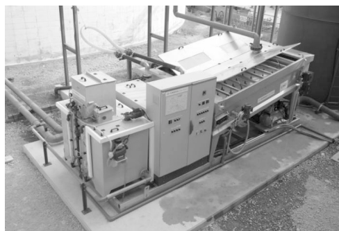
写真1 ベルト濃縮機実験ユニット
