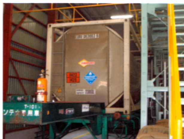
写真4 ナトリウムタンクコンテナ
