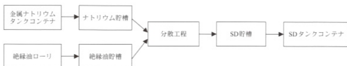
図2 SD 製造プロセス
