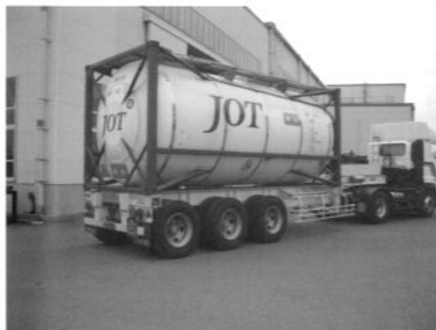
写真7 SD タンクコンテナ
