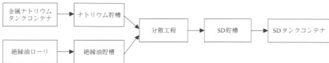
図2 SD製造プロセス
