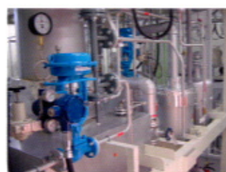
—溶剤再生ステーション— 使用後の溶剤を蒸留・再生する
