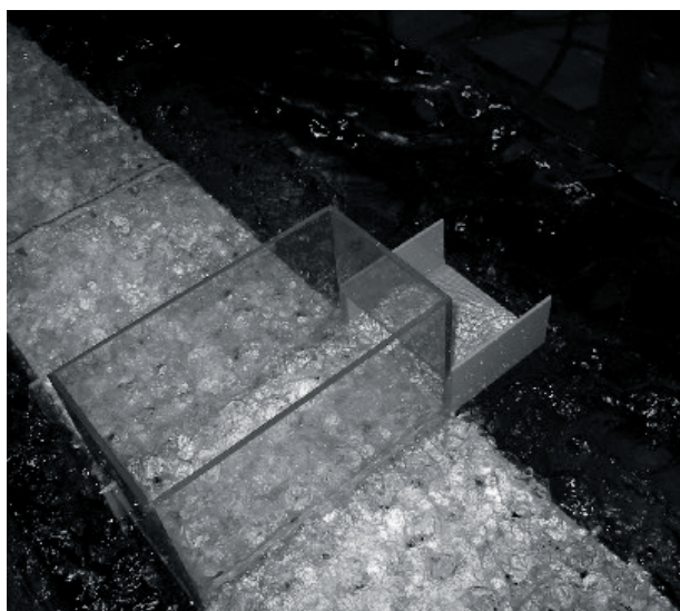
写真4 水量均等性計量ボックス
