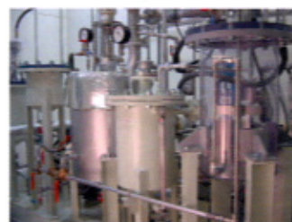
—油処理ステーション— PCB を脱塩素化無害化処理する
