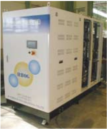
写真3-2 高圧水素サーバ CH-5D（除湿器付帯） (5 m 3 N /h, 0.82 MPa, 900 W×1 700 L×2 000 H)
