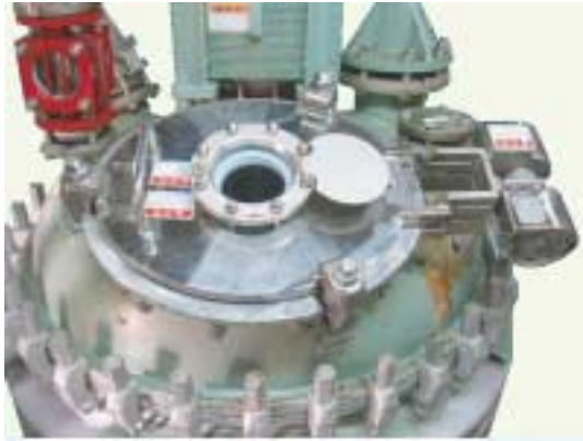
写真4 φ300×400 E-マンホール据付状態
