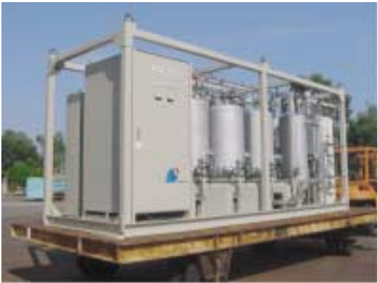
写真3-1 高圧型 HHOG スキッドマウントタイプ 納入装置 SH-30D（除湿器付帯） (30 m 3 N /h, 0.82 MPa, 5 700 W×2 000 L×2 500 H)
