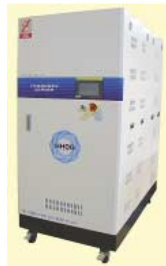
写真2 水素サーバ CL-5 (5 m 3 N /h, 0.4 MPa)
