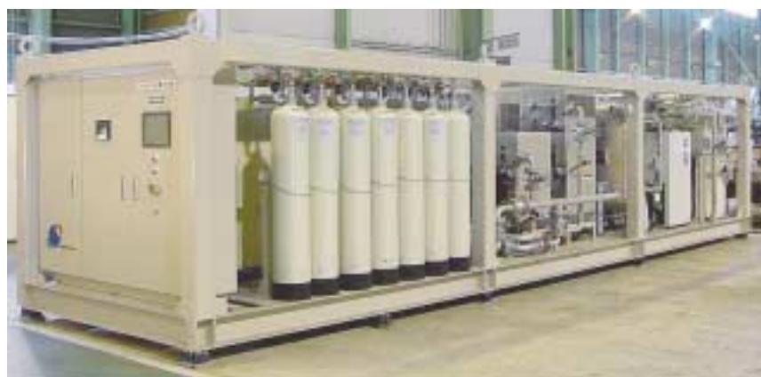
写真1 低圧型 HHOG スキッドマウントタイプ納入装置 SL-50 (50 m 3 N /h, 0.37 MPa)
