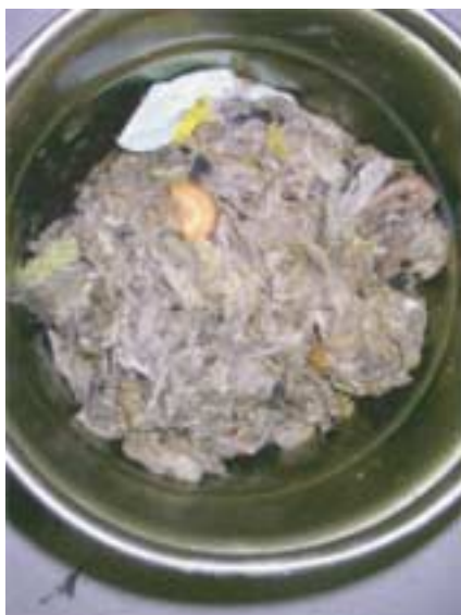
写真2 洗浄脱水前のし渣 含水率 91.5 % SS 116.0 g/kg(dry)
