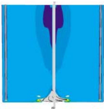
図13 PABIO MIX を回転 (20 rpm)
