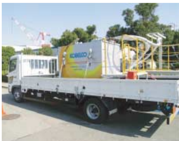
写真1 パイロットスケール蓄熱装置
