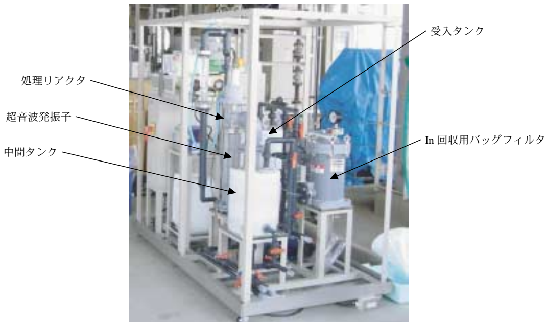
図2 循環型処理実験装置外観写真
