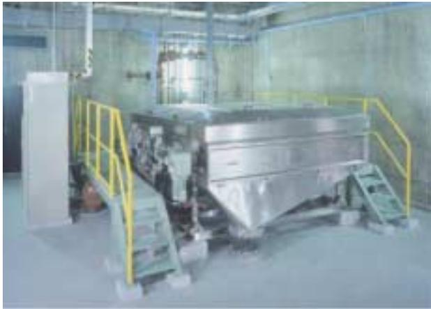
写真1 ベルト型濃縮機外観
