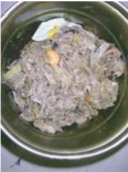
写真2 洗浄脱水前のし渣 含水率 91.5 % SS 116.0 g/kg(dry)
