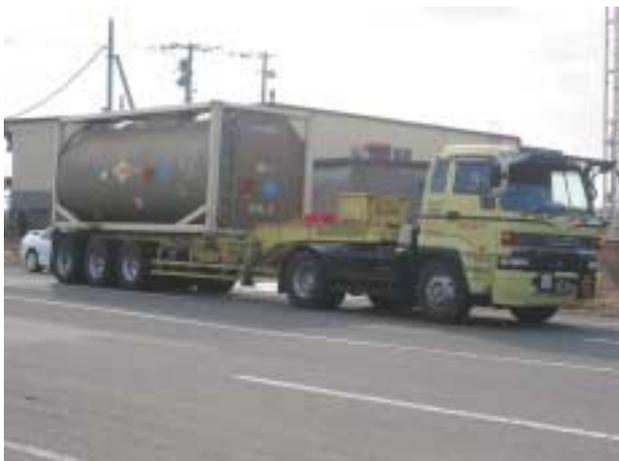
写真3 ナトリウムタンクコンテナ
