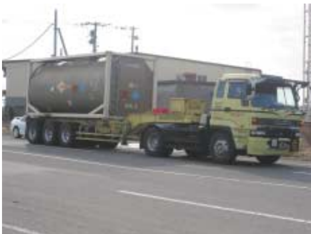
写真3 ナトリウムタンクコンテナ
