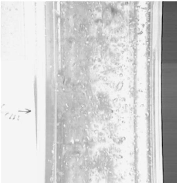
写真3 装置中段部分における気泡の様子 (10 L/min)
