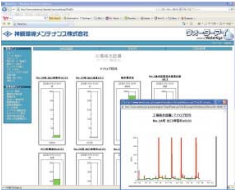
図5 純水装置の監視画面例
