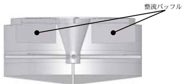
図6 整流バツフルの概要
