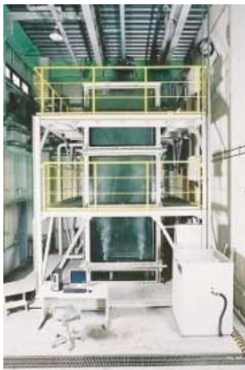
写真3 清水試験水槽 (2 m<sup>w</sup> × 2 m<sup>t</sup> × 5 m<sup>d</sup>)
