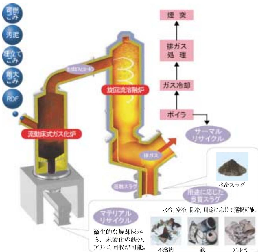
図1 流動床式ガス化溶融炉
