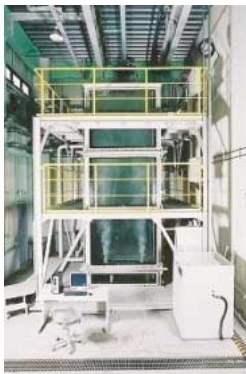
写真3 清水試験水槽 (2 m w × 2 m t × 5 m d )
