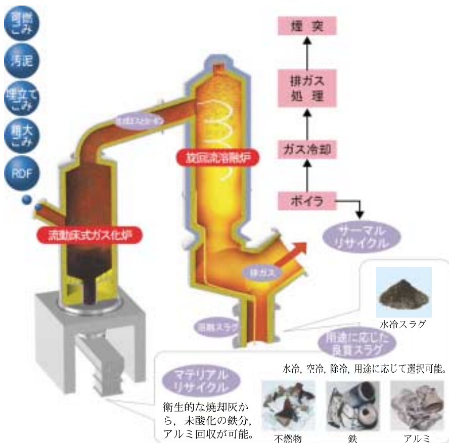
図1 流動床式ガス化溶融炉
