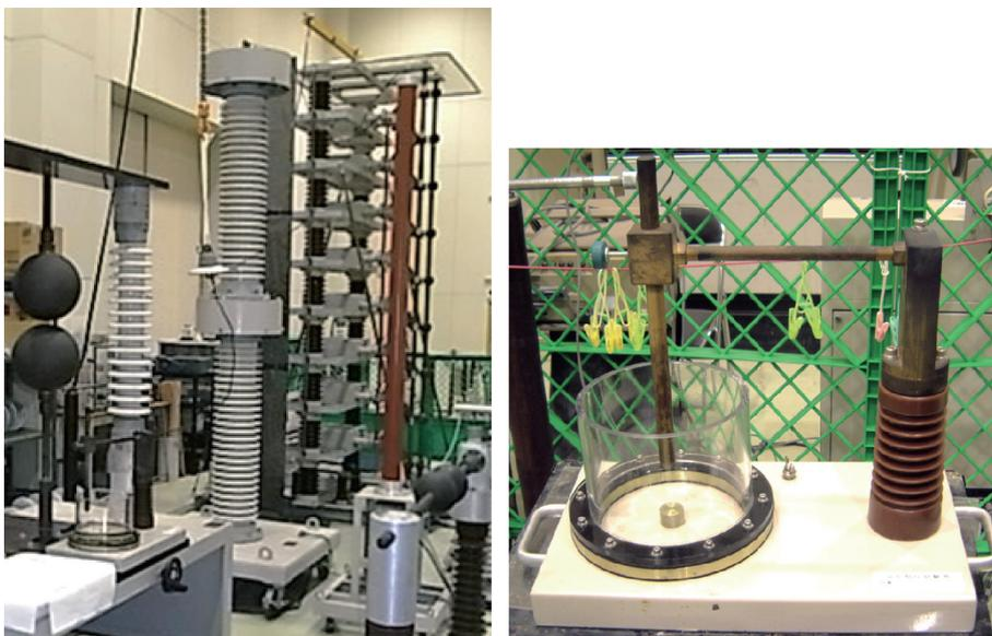
(a) 装置外観 (b) 油中電圧印加部
