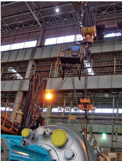
写真11 吊り下げ式秤での重量測定作業
