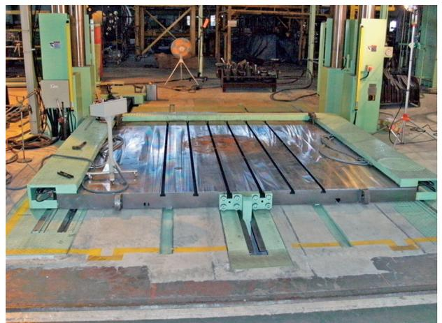
写真9 新プレスの底盤の移動機構
