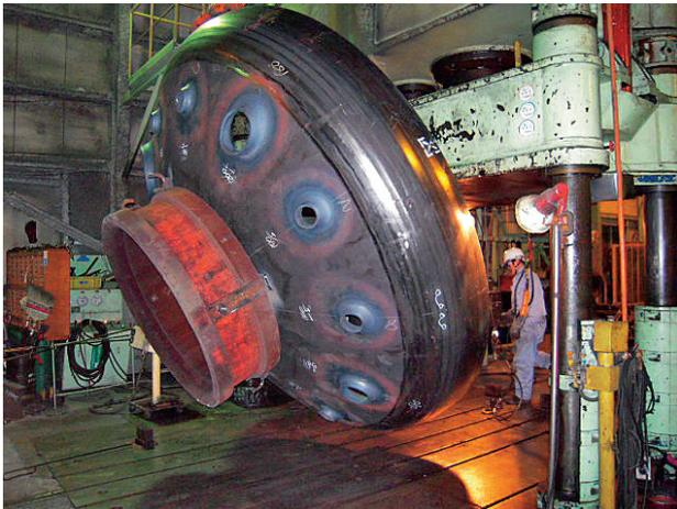
写真10 旧プレスでの被加工物の引き込み作業
