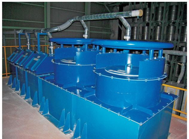
写真13 配合機投入口の形状変更
