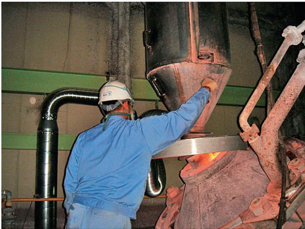
写真14 局所排気フードの形状変更
