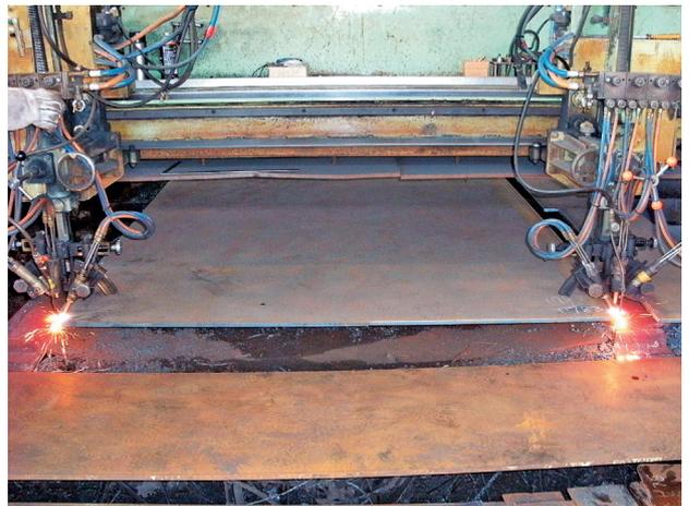
写真6 水素ガスによる鋼板切断状況
