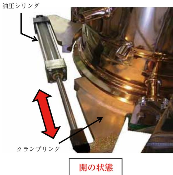
図2 ヘルール式急速開閉装置 (サニタリー仕様)
