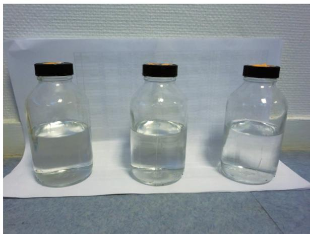
写真4 プラズマ改質炉後でのタール採取ビン
