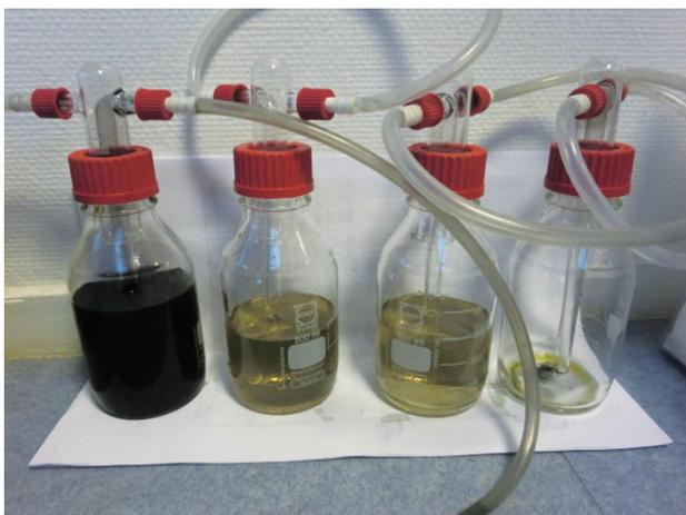
写真3 ガス化炉出口でのタール採取ビン
