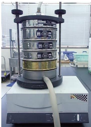
写真2 電磁式ふるい振とう機
