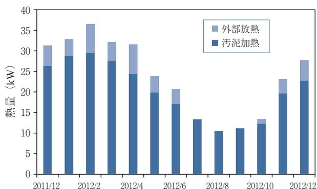
図5 鋼板製消化タンクの熱収支の推移 (千葉実証)
