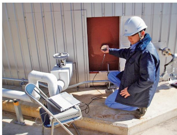
写真2 超音波による堆積物測定状況
