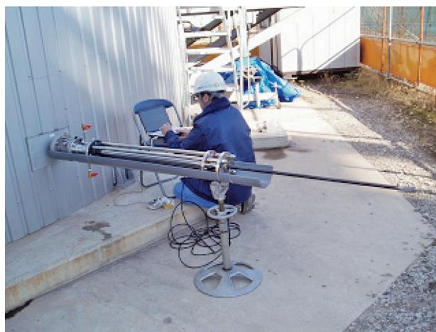
写真4 流速測定状況
