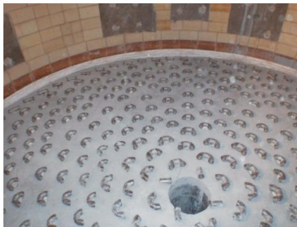
写真2 空気分散板
