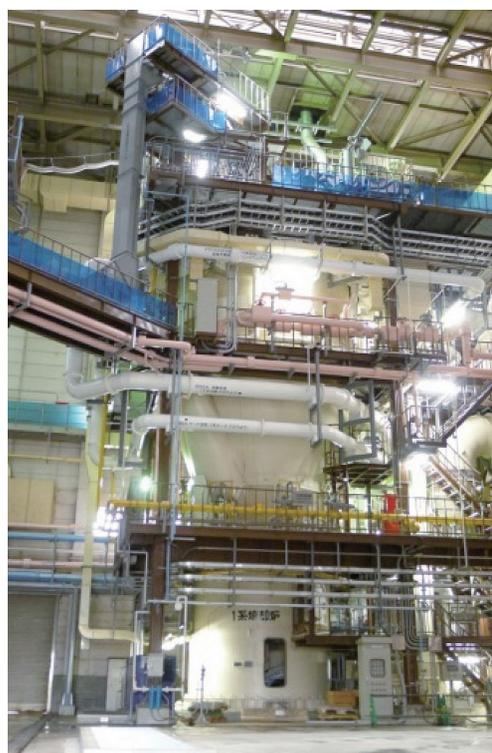
写真1 気泡式高効率二段燃焼炉
