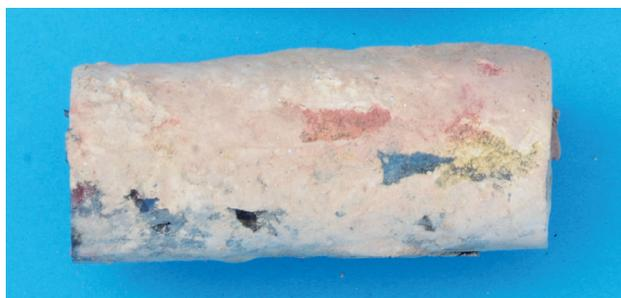
写真3 切断採取したプローブ材の外観性状
