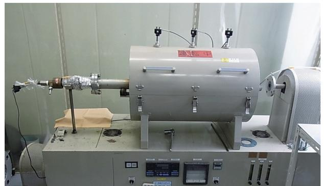
写真1 回転式電気炉の外観
