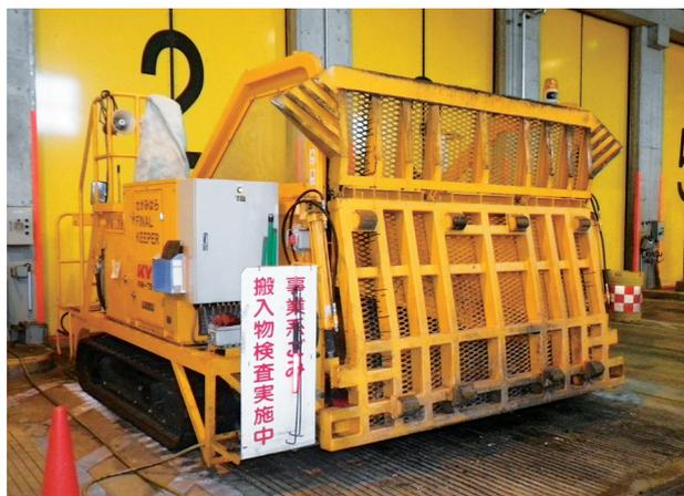
写真2 自走式ごみ検査装置の外観
