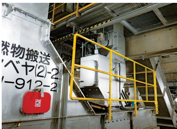
写真3 異物除去装置の外観
