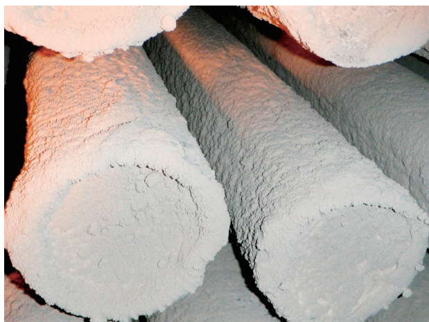
図2 ろ布ダスト層の表面の例
