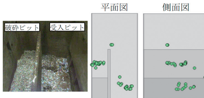
図6 両眼ステレオ方式によるごみ高さ取得結果
