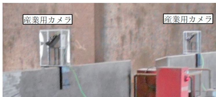
図3 測距センサ(左:レーザー方式, 右:両眼ステレオ方式)
