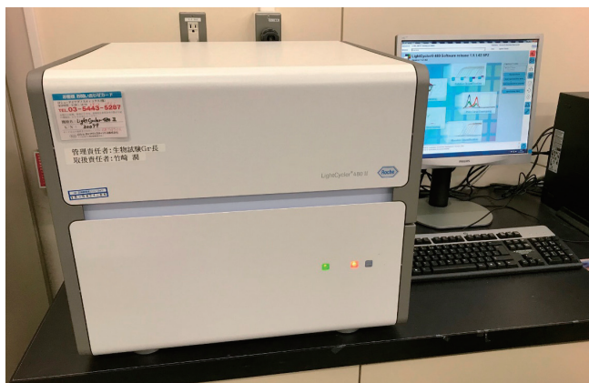
リアルタイム PCR 装置 (Roche 社製 LightCycler® 480 system II)
