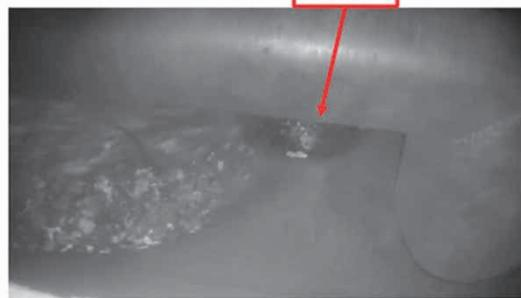
図7 不燃物貯留槽下スクリーユの異常状態
