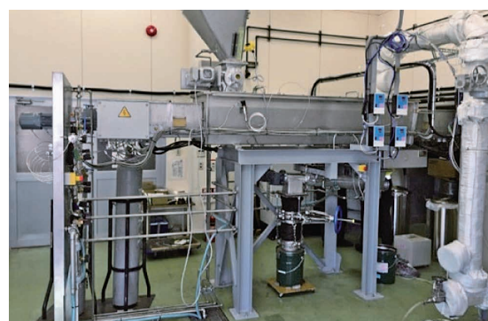
写真1 電熱スクリュ式炭化炉外観 （脱水汚泥量換算 1 t-wet/d 規模）
