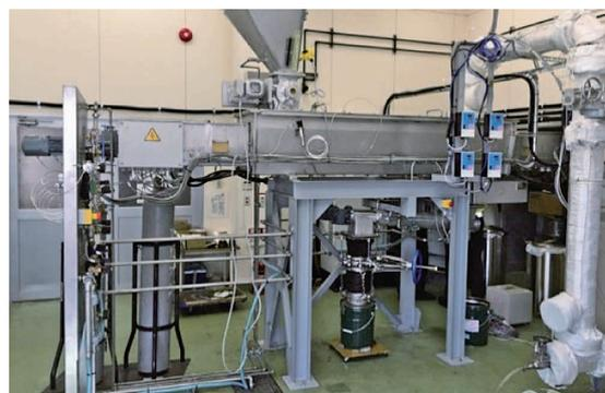
写真1 電熱スクリュ式炭化炉外観 (脱水汚泥量換算 1 t-wet/d 規模)
