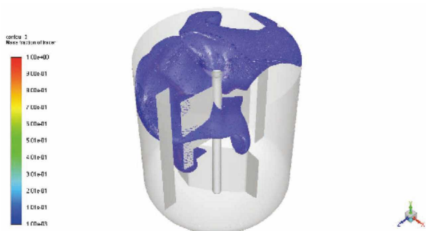
図6 CVDによるフルゾーン翼の解析事例
