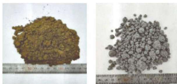
図5 炭酸化物（左：粉体，右：造粒物）
