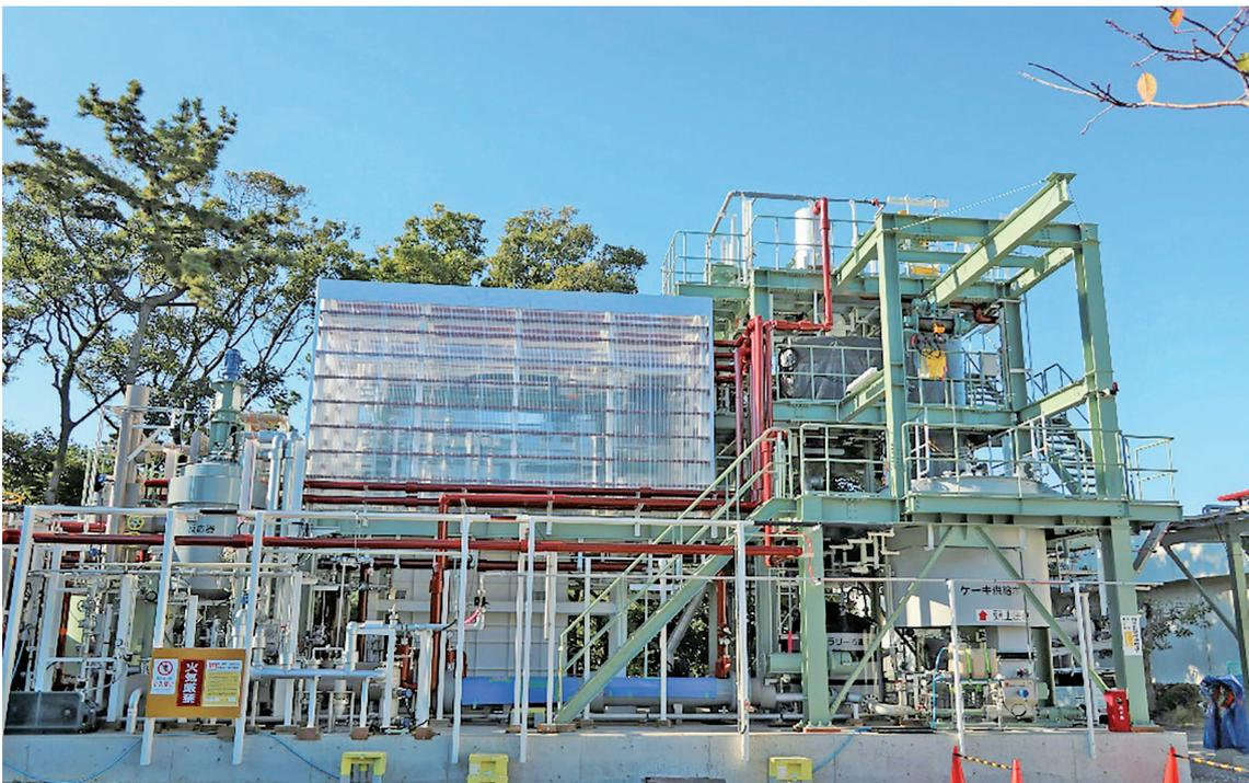
実証設備の外観（施設規模：脱水汚泥処理能力 5 t-wet/日）
