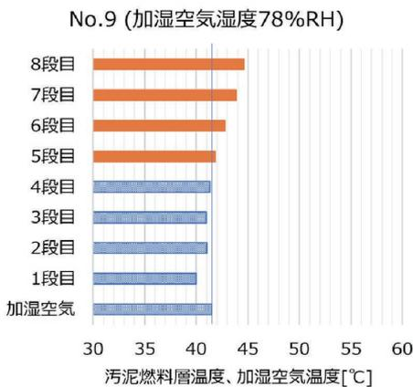
図9 空気湿度と汚泥燃料層内の温度差
