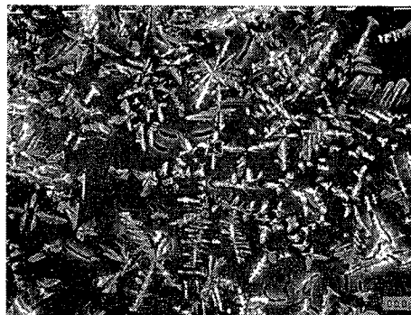
写真1 結晶化ガラスの走査型電子顕微鏡写真 Photo.1 SEM of crystallized glass
