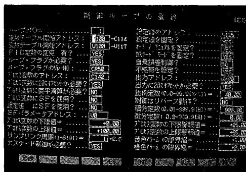
写真2 制御ループの登録例 Photo.2 Register of control loop
