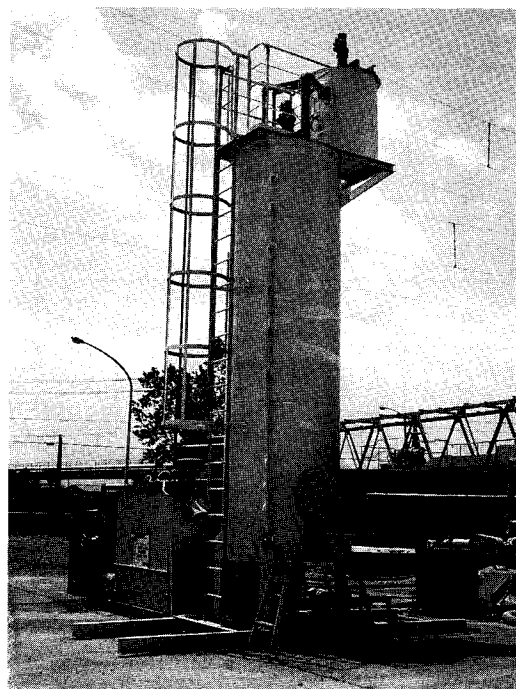
写真 1 高速凝集沈殿装置『スーパーシックナー』 Photo.1 High Rate Sedimentation Unit "Super Thickener"
