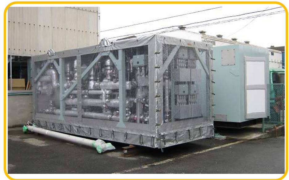
微量PCB洗浄装置外観
