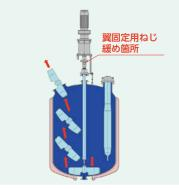
撹拌軸上部から翼固定用ねじを緩め、翼を取り
