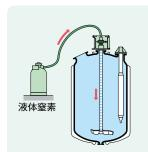
翼取外しには、まず減速機を外し 撹拌軸内に液体窒素を送入します For blade detaching, first remove the reducer and then supply liquid nitrogen into agitator hollow shaft.
