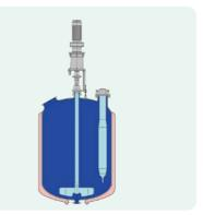
缶体内面のグラス面の養生等、翼取外しの準備 を行います。
