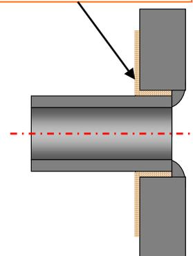
水・ブライン併用時の管板部での冷却水の凍結によるトラブルを解消。
