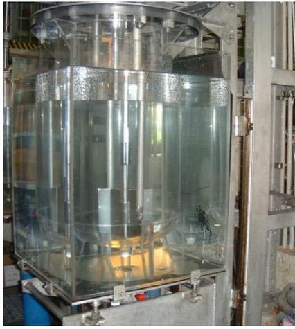
模擬液を使用し、攪拌槽内部の流動状態を観察することができます。
