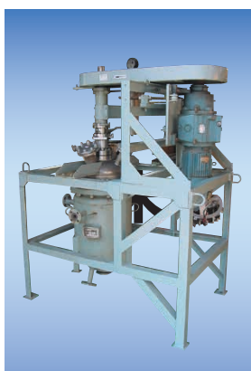
SUS316製60ℓテスト装置
