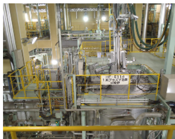
プラズマ溶融分解炉 (写真提供：日本環境安全事業株式会社)
