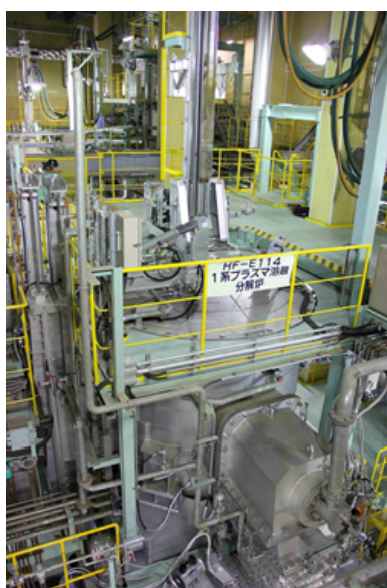
プラズマ溶融分解炉 (写真提供：日本環境安全事業株式会社)
